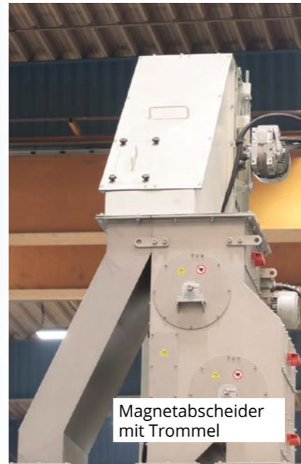
Magnetabscheider mit Trommel
