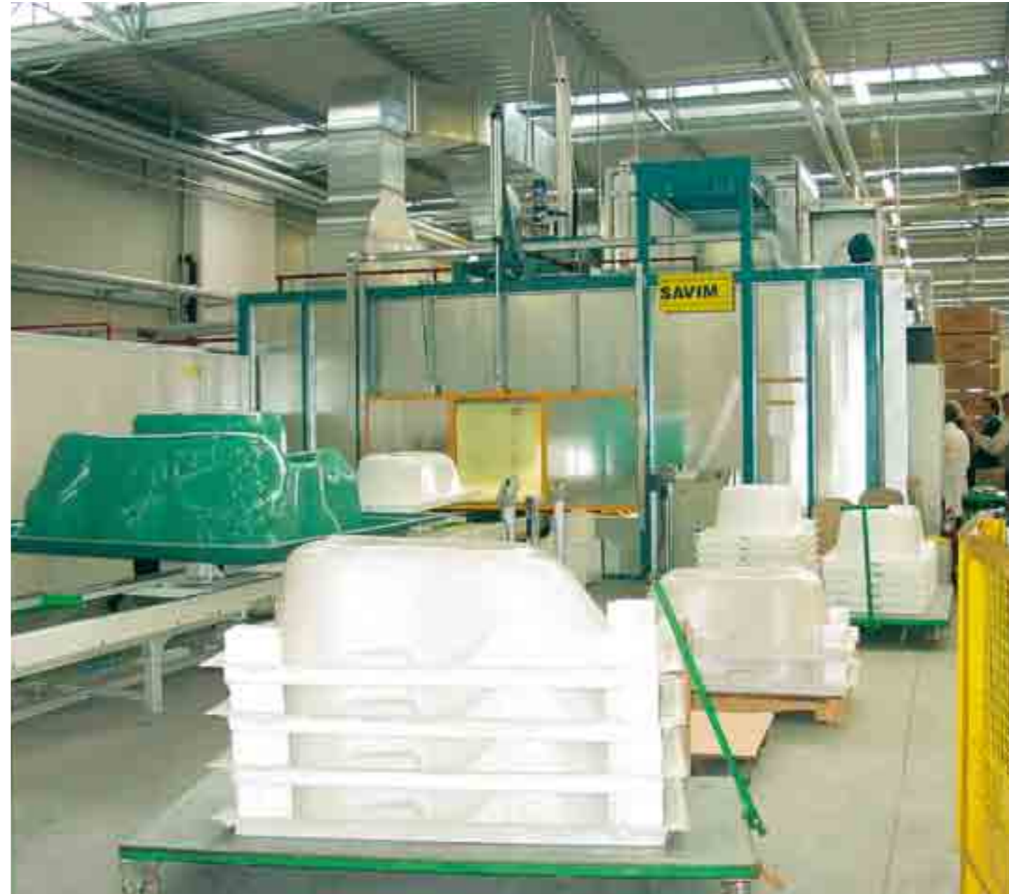
Impianto automatico di rinforzo vasche e piatti doccia.
