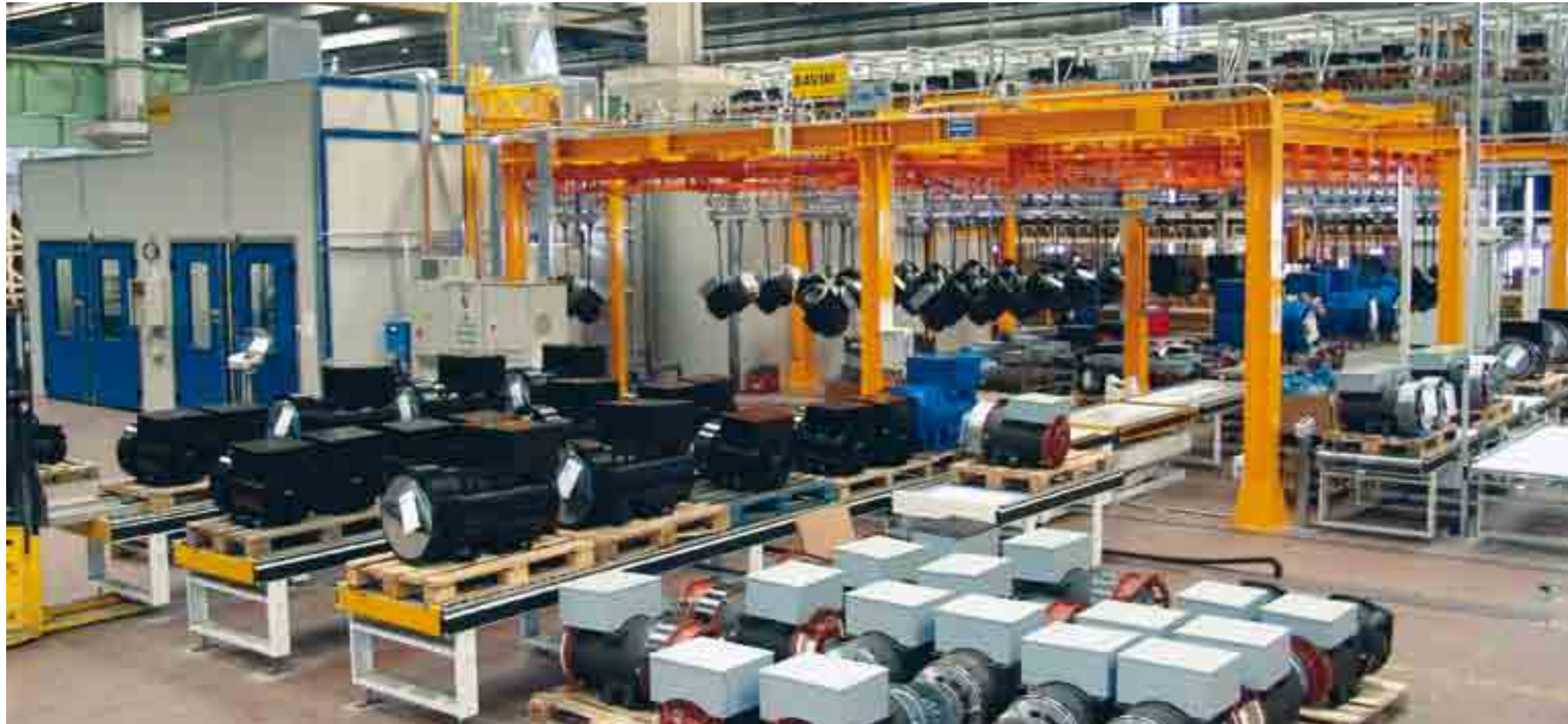
Impianto di verniciatura a liquido robotizzato con vernici idrosolubili su motori e generatori elettrici con trasportatore aereo bi-rotaia e robot antropomorfo, installato presso la ditta: MarelliMotori SpA Sede di Arzignano (Italy).
