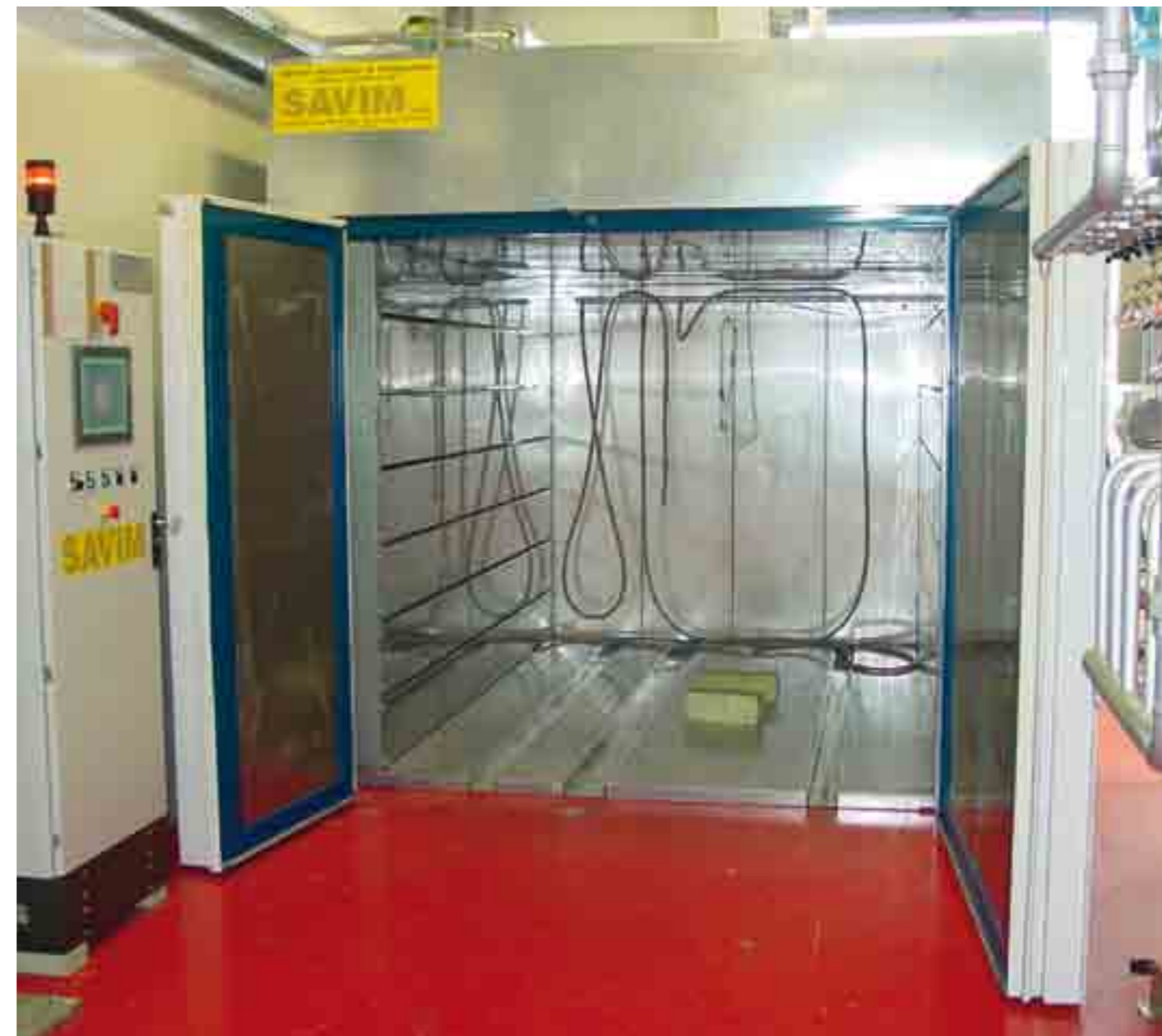
Forno elettrico per polimerizzazione telai in fibra di carbonio con gestione delle temperature per mezzo di PLC.
