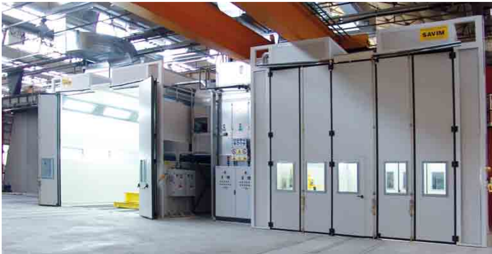
Cabine forno di verniciatura con porte pneumatiche superiori, pedane porta operatore e carri porta pezzi.
